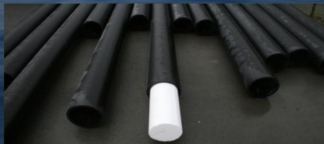
Σωλήνες εύκαμπτου πολυαιθυλενίου με πολυστερίνη στο εσωτερικό για διατήρηση της πλευστότητας του συστήματος
